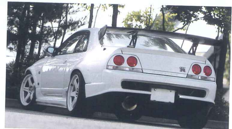
前後オーバーフェンダー化にあわせて純正フェンダーを大きくカット。リヤはインナー&アウターパネルを溶接し直すなど大幅な加工が行われている。結果、全幅を100mm拡大した迫力のボディとワイドトレッド化によるコーナリング性能の向上を実現。まさに、機能とルックスを両立したエクステリアチューンだ。
