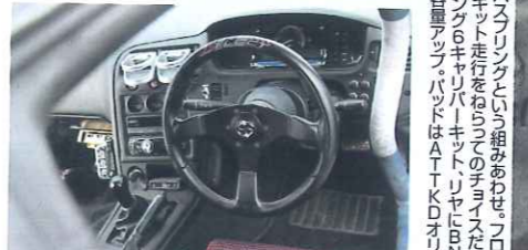
車両の各種情報はスタックST8100で集中管理。機能的なだけでなく、ダッシュボードまわりをシンプルに仕上げるのにもひと役買っている。また、グローブボックス部にはVプロがセットされるほか、エアコンやオーディオといった快適装備もしっかり残されている。
